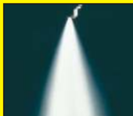
Injecteur de carburant propre
