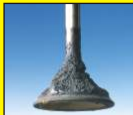
Soupape d'admission encrassée
