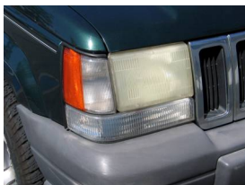
Phare décoloré avant la restauration
